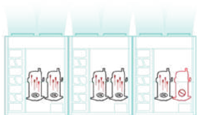
Segunda protección (cuando falla cualquier compresor)
